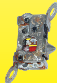
Déclencheurs thermiques en acier zingué après 120H d'essai au brouillard salin à 20%
