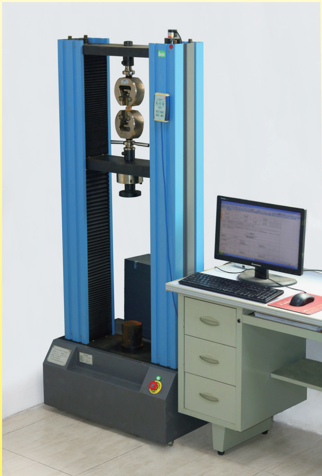
Equipement d'essai de traction (mesure de l'élongation à la rupture et de la force à la rupture)
