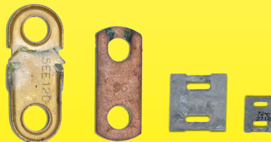
Déclencheurs thermiques en laiton brut, en cuivre brut, et recouverts d'alliage fusible après 120H d'essai au brouillard salin à 20%
