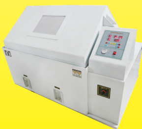
Equipement d'essais de résistance à la corrosion (Brouillard salin) dans notre laboratoire
